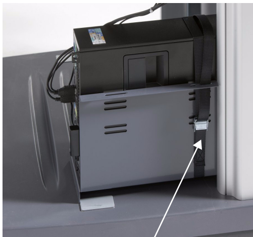
Рисунок 5-5: Прикрепите ремнями компьютер к подставке, которая находится на левой стороне устройства (опционально).
