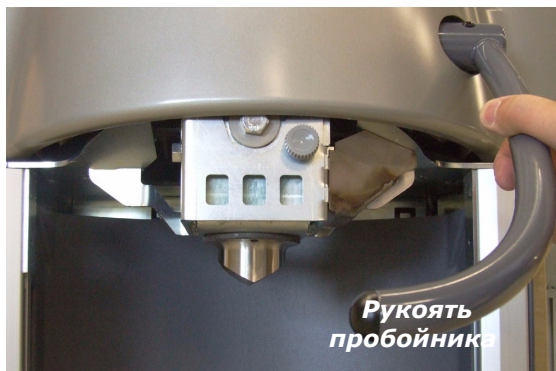
Рисунок 6-8: Лезвие для пробивания крышки банки с краской в нижнем положении.
