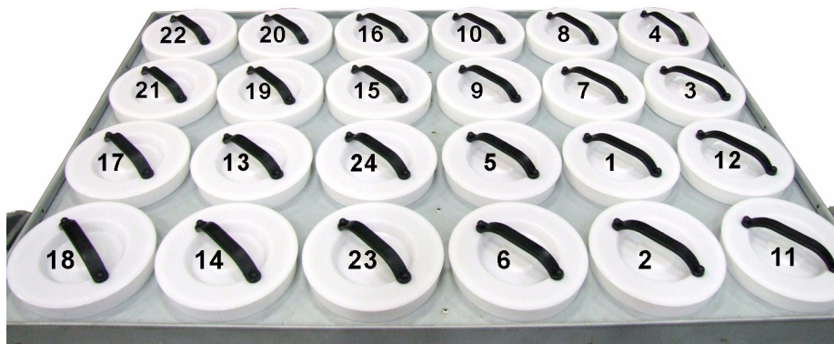
Рисунок 8-25: Банки пронумерованы в указанном выше порядке. Иллюстрация была сделана с передней части машины.
